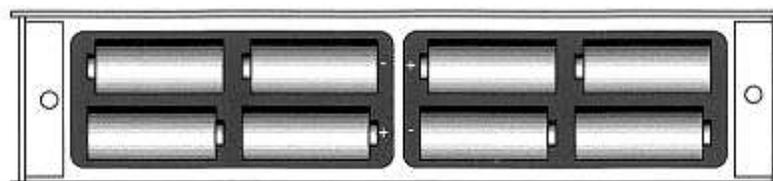
**Nous recommandons de n'utiliser que des jeux de piles alcalines neuves. Il est néanmoins possible d'utiliser des accumulateurs rechargeables. Dans ce cas,**
