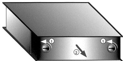
Pour insérer des piles neuves, ouvrir le capot arrière en dévissant les deux vis "quart de tour" au moyen d'un gros tournevis ou d'une pièce de monnaie.
